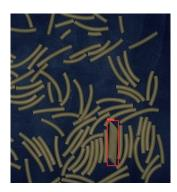
**Détection** d'un corps étranger dans des pâtes (mélange de produits)
