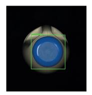
**Présence** de bouchon sur bouteille de lait
