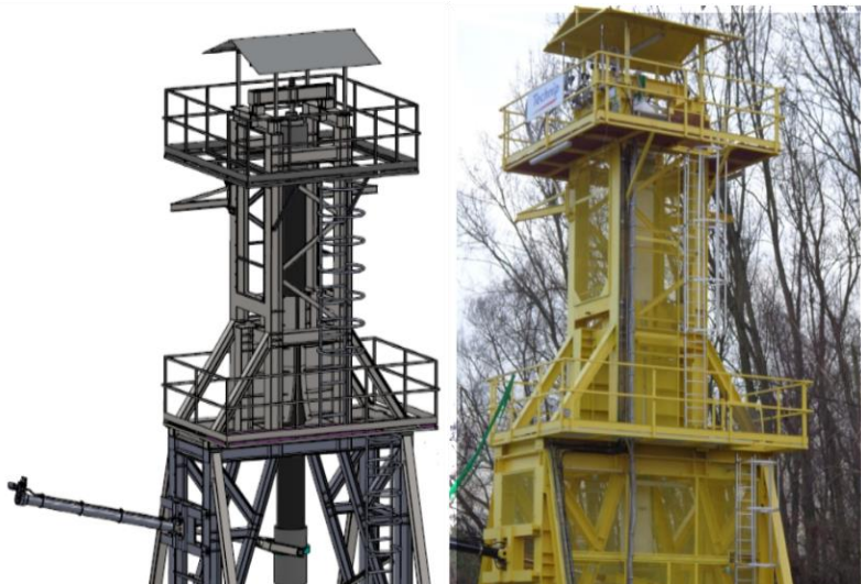
Banc hydraulique, flexion verticale sur tuyaux flexibles (16 pouces, longueur 10 mètres) : test de fatigue cryogénique sous pression régulée
